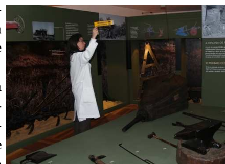
Psicrómetro de roca, para medição pontual de humidade relativa e temperatura
