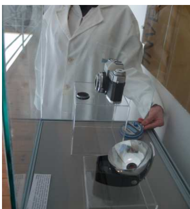
Datalogger, para registo contínuo de valores de temperatura e humidade relativa
