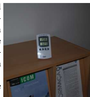
Termo-higrómetro, para medição de valores de temperatura e humidade relativa
